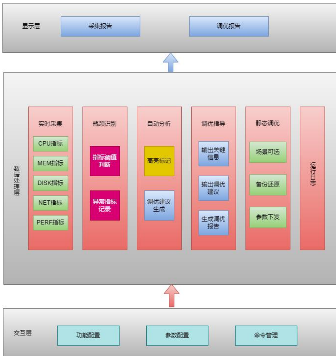
图 17 性能收集工具架构图
